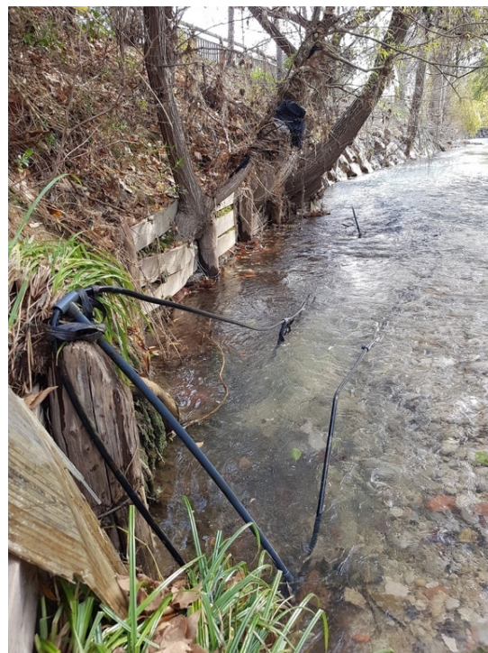
Figure 50 : Antenne endommagée lors de la crue cinquantennale (MRM)
