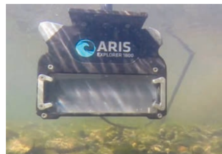
Figure 48 : Caméra acoustique ARIS immergée (Université de Perpignan)
