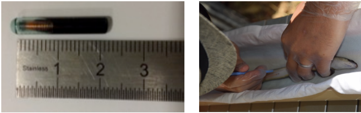
Figure 41 : Marque Pit Tag (à gauche) et chirurgie pour insertion de la marque (à droite)
