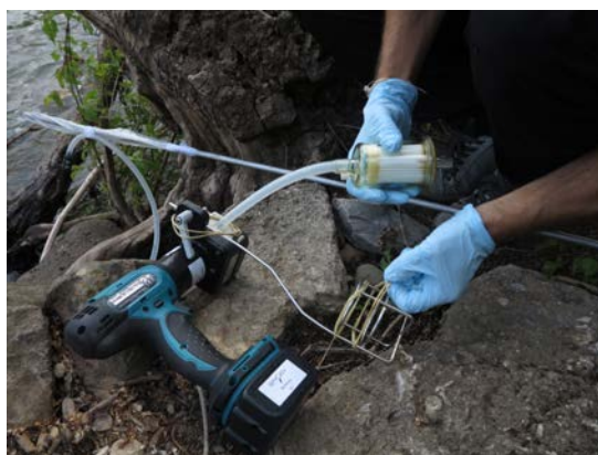
Figure 56 : Pompe utilisée pour la filtration de l'eau (MRM)
